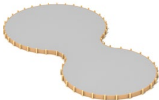
Grunnen er en støpt bunnplate på bakken.
