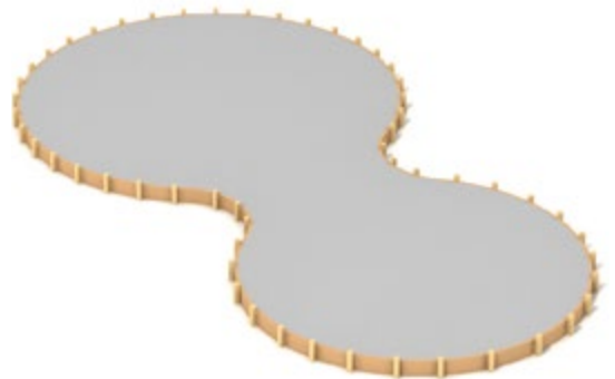
Grunnen er en støpt bunnplate på bakken.
