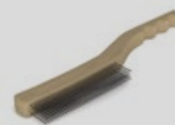
Stålbørst. Brukes til å rengjøre flater som skal repareres
